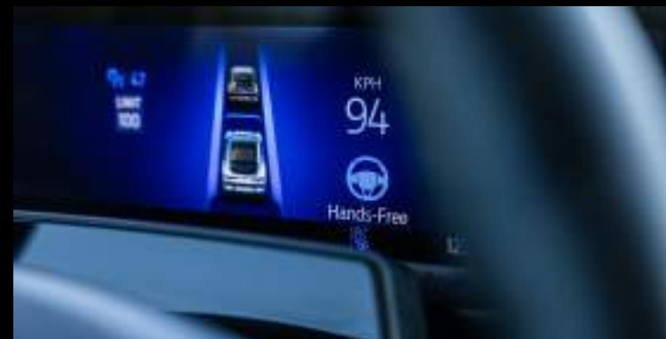
Ford BlueCruise - zaawansowany system wspomagania kierowcy umożliwiający jazdę bez trzymania rąk na kierownicy na autostradach
