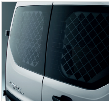
Tylna osłona ochronna szyby do drzwi bagażowych (1 828 355)
