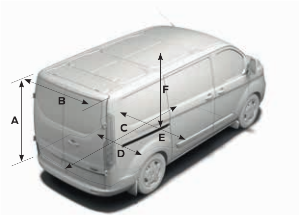
Podstawowe wymiary przestrzeni ładunkowej (mm)
