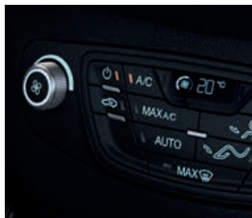
Klimatyzacja z automatyczną regulacją temperatury (EATC)
