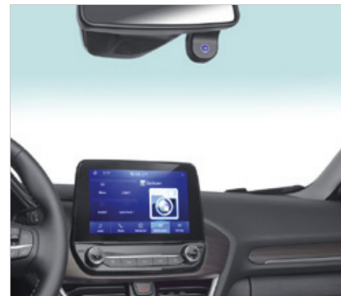
KAMERA SAMOCHODOWA Z REJESTRATOREM (FULL HD) STEROWANA Z POZIOMU SYNC3 I APPLINK (2 421 817)
