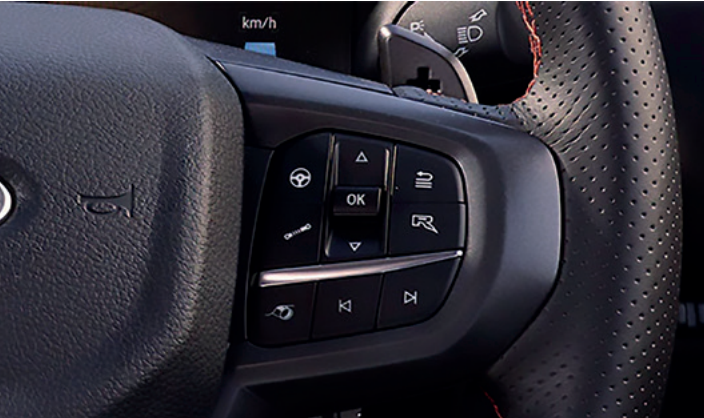
MOŻLIWOŚĆ WYBORY TRYBU PRACY: AMORTYZATORÓW, UKŁADU KIEROWNICZEGO I UKŁADU WYDECHOWEGO NA KIEROWNICY Standard dla wersji z silnikiem benzynowym
