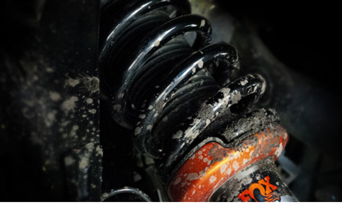
AMORTYZATORY FOX™ LIVE VALVE™ - Z MOŻLIWOŚCIĄ WYBORY TRYBU PRACY Standard dla wersji z silnikiem benzynowym
