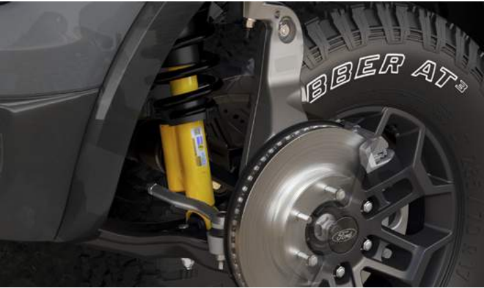
ZAWIESZENIE BILSTEIN - TERENOWE Standard dla wersji Tremor i Wildtrak X
